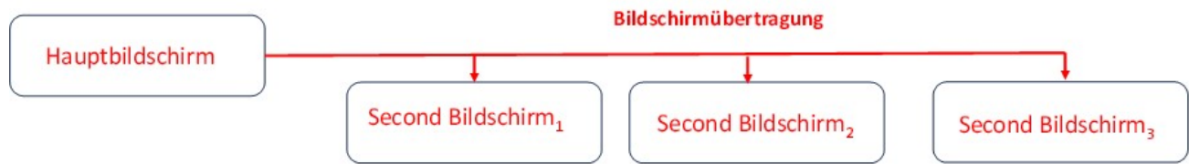
Abbildung 10: Schema Videostream über mehrere Bildschirme
